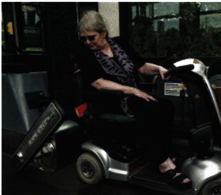
Bild 43: Automatisiertes Sicherungssystem für Rollstühle und Elektromobile (hier Sicherung eines Elektromobils) [100]
