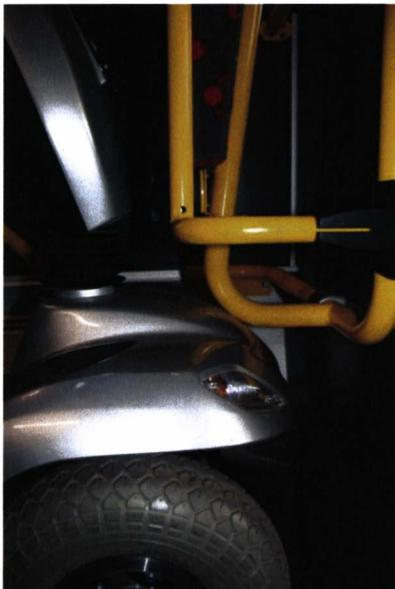
**Bild 25:** Berührung der vorderen Abdeckung des Elektromobils an den unteren Verbindungsstangen des Rückhaltesystems bei der Aufstellung in Fahrtrichtung des Busses
