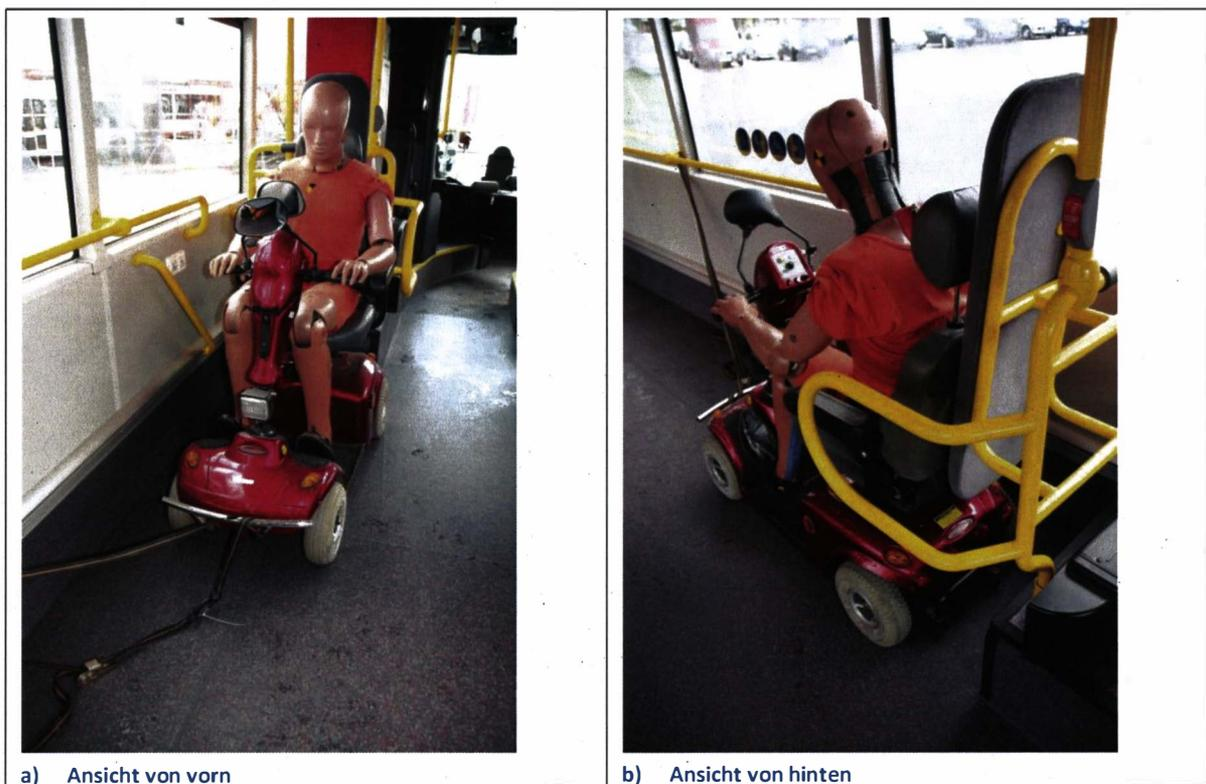
Bild 40: Aufstellung des Elektromobils am Rollstuhlaufstellplatz mit Ausstattung gemäß UN/ECE Nr. 107 während der Testfahrt (Stabilitätstest)
