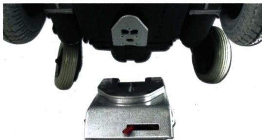
Bild 46: Verriegelungsplatte am Rollstuhl und Docking-Station (Quelle: Dahl Engineering)
