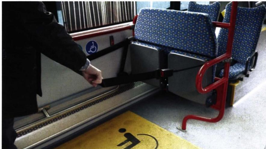
Bild 41: Zusätzliches Gurtsystem zur Sicherung von Elektromobilen am Rollstuhlstellplatz – Beispiel Kassel (Foto: KVG/Wiesenhütter)
